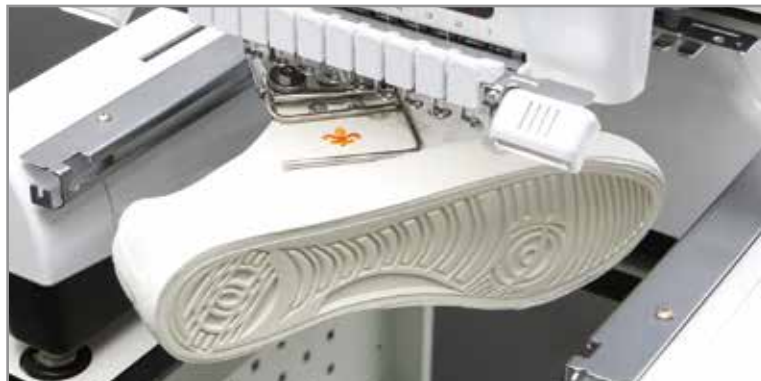
Установка обуви большого размера
