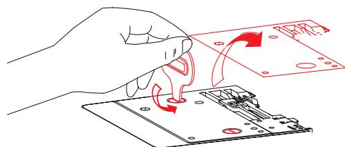
> Удалите пыль и обрезки ткани и ниток пинцетом или пылесосом.
