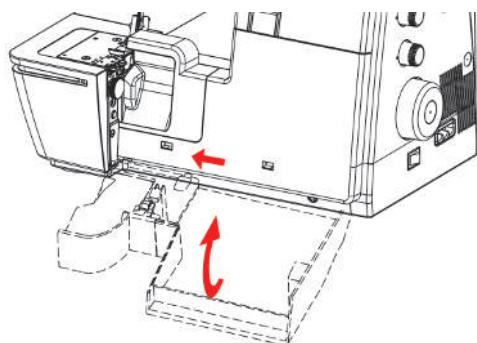
Если крышка нитевдевателя на закрывается полностью, значит, соединение пневмозаправки не включено.
