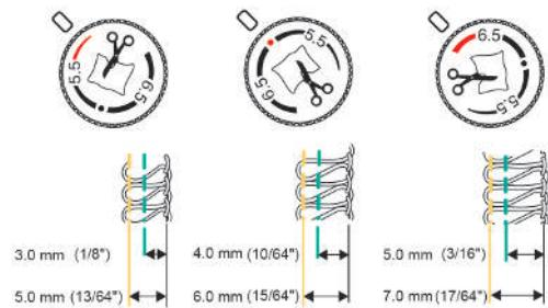
Цифры на шкале соответствуют эффективной ширине обрезки в мм от левой оверлокной иглы «LN» до срезанного края. Ширина обрезки используется, чтобы определить ширину строчки. (См. стр. 50)
