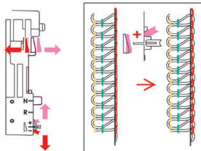
> Чтобы уменьшить петлю нитки петлителя на срезанном крае, перемещайте микрорегулятор нитки mtc во время шитья в направлении «-».
